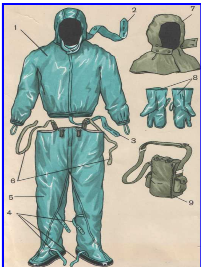
1 – куртка з капюшоном; 2 – шийний клапан; 3 – проміжний хлястик; 4 – хлястики; 5 – штани з панчохами; 6 – плечові лямки штанів; 7 – підшоломник; 8 – трипалі рукавиці; 9 – сумка для протигазу
